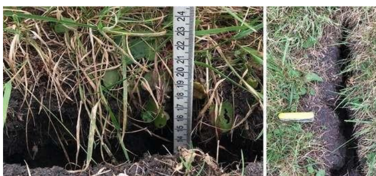
Figuur 12. Bodemprofiel van het onderzoeksperceel. A: Toemaakdek in de bovenste 43 cm van het profiel, met locatie van de monsterringen. B: veenprofiel onder het toemaakdek. C: verticaal in elkaar gedrukt wilgenhout(oranje) in het veen; dit wijst op compactie. Profielbeschrijving in Tabel 1.
