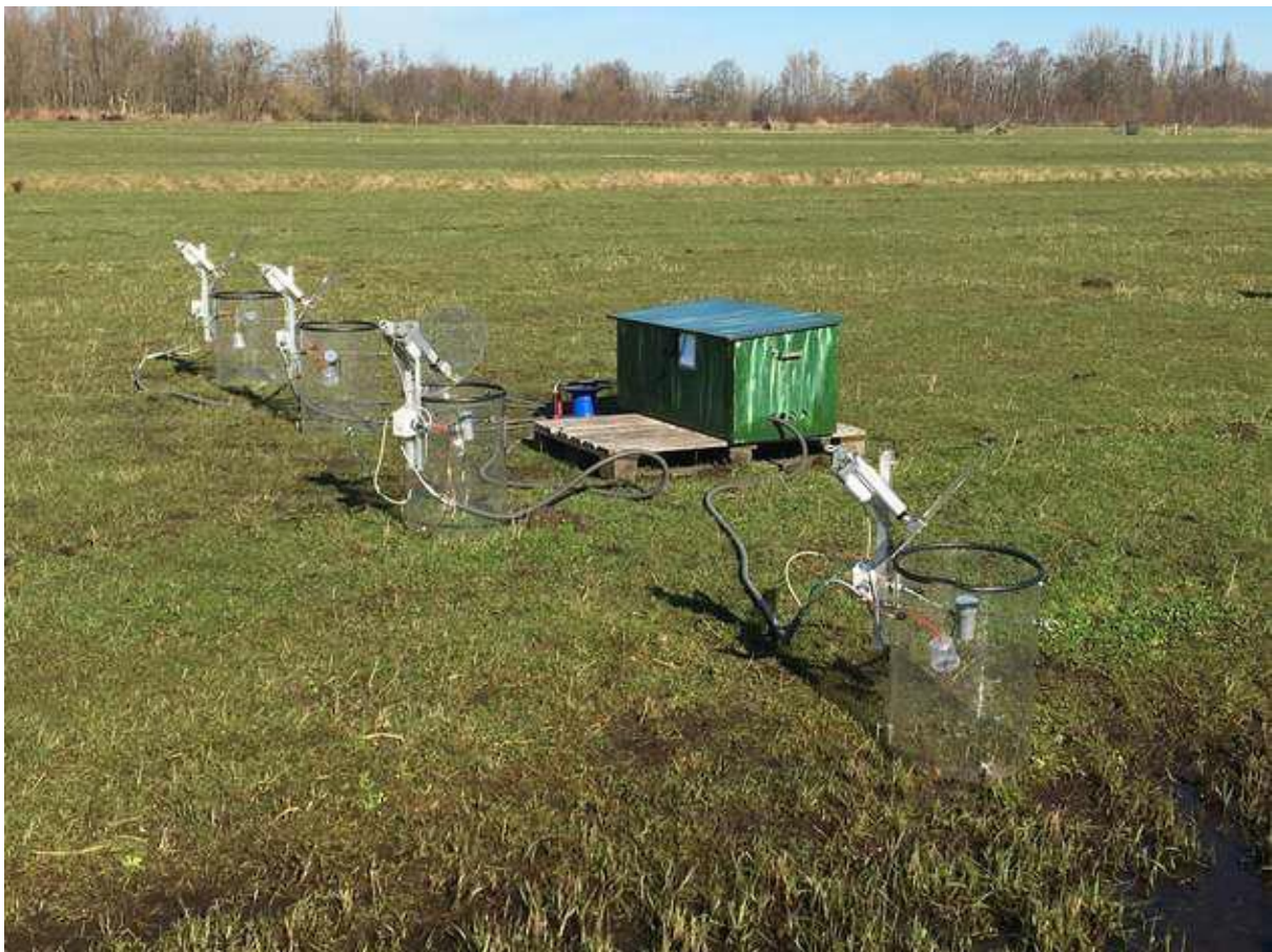
Figuur 5. Het automatische kamersysteem voor meting van de broeikasgasfluxen op de meetlocatie bij het referentieperceel. In de groene kist bevinden zich de controlebox en de gasanalyser.
