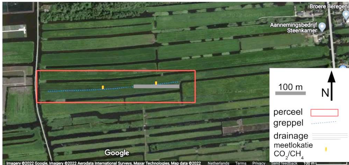
Figuur 3. Ligging van het proefperceel, de aangelegde onderwaterdrainage en de meetlocaties.
