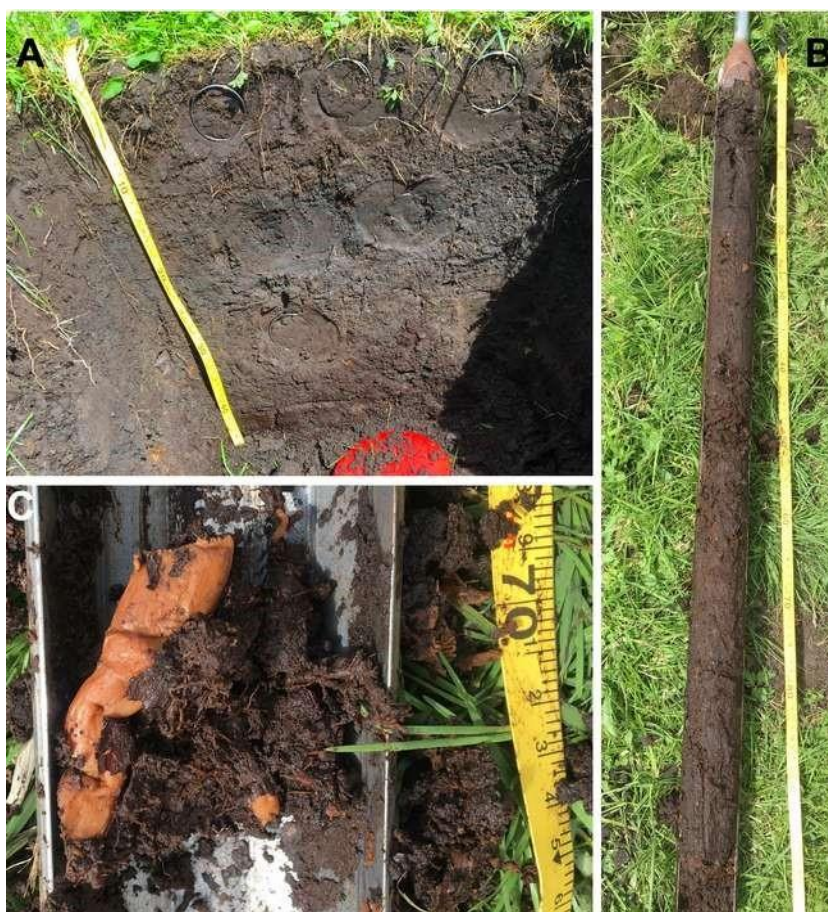
Figuur 12. Bodemprofiel van het onderzoeksperceel. A: Toemaakdek in de bovenste 43 cm van het profiel, met locatie van de monsterringen. B: veenprofiel onder het toemaakdek. C: verticaal in elkaar gedrukt wilgenhout(oranje) in het veen; dit wijst op compactie. Profielbeschrijving in Tabel 1.
