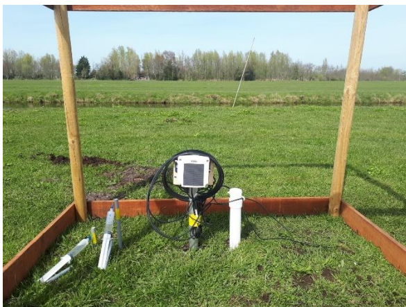
Metingen aan het water in het perceel (links) en aan de broeikasgassen (rechts).
